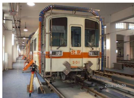
北京市地铁十号线限界检测
