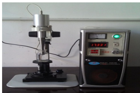
自主研发的大功率超声加工系统
