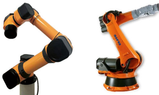
自主研发并产业化的模块化协作机器人 (左)和通用六自由度机器人(右)
